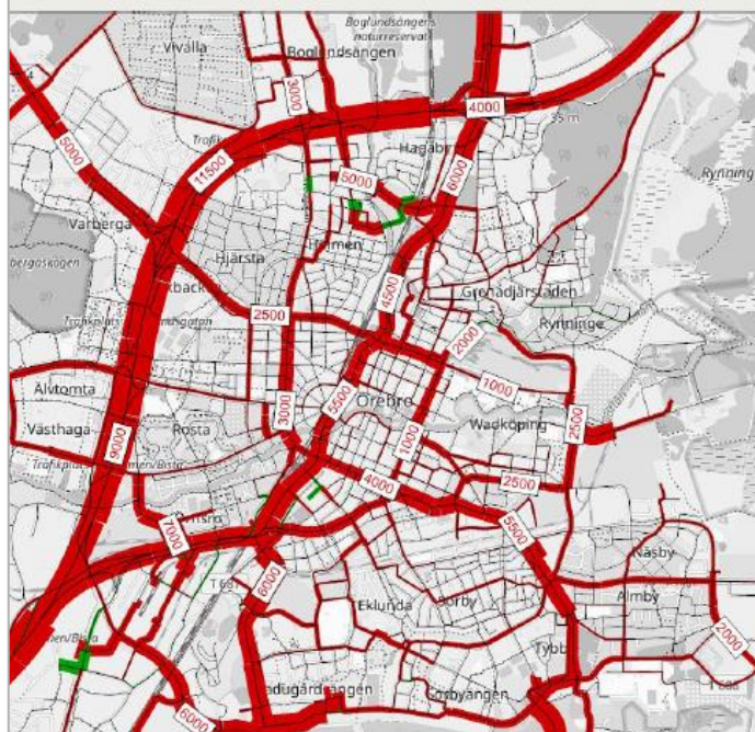
Karta 10: Fordonsflöde biltrafik 2040 Visum modell nollalternativ utan förändring i infrastruktur och färdmedel (Örebro kommun)
