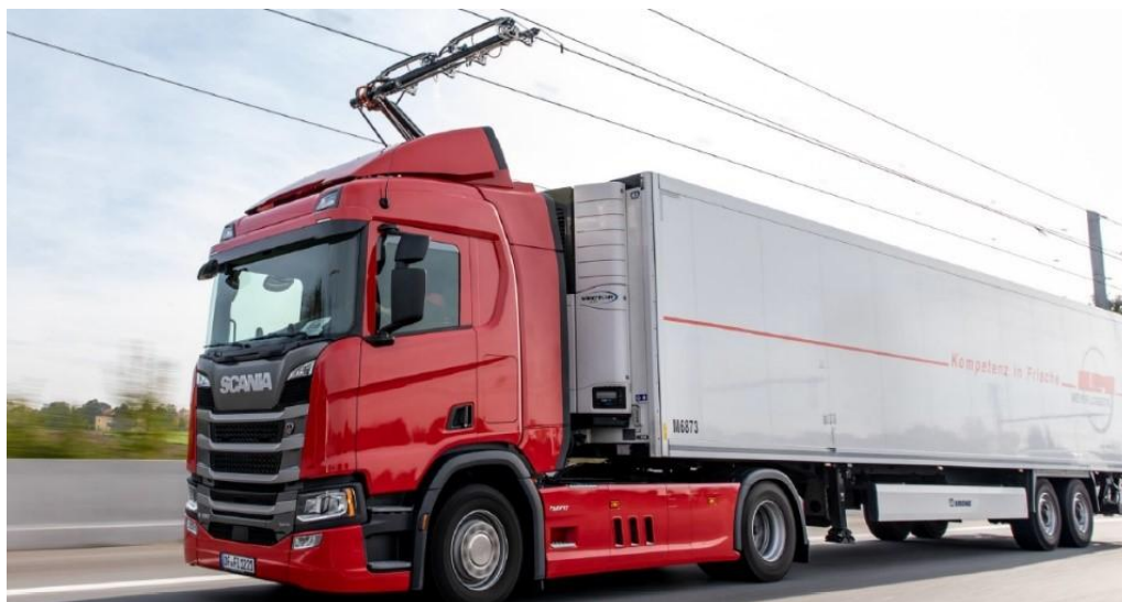
Figur 3.6 Siemens luftledningar med lastbil
