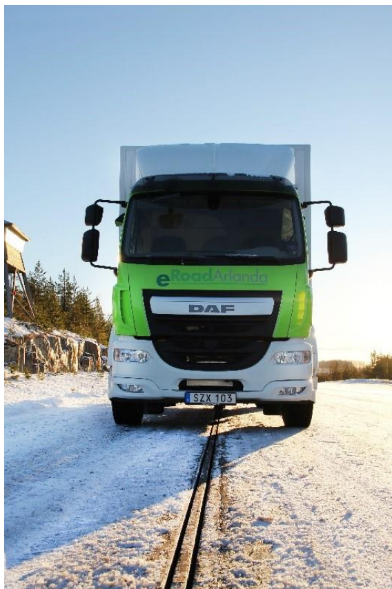
Figur 3.8 Elways nedsänkta skena med lastbil
